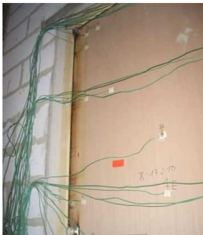
Messpunkte zur Temperaturbestimmung während der Prüfung
