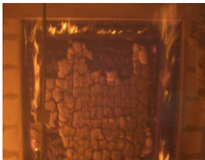
Brandschutzrohling während der Prüfung
